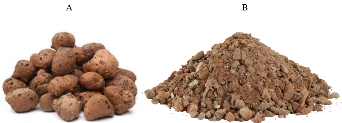
Obr. 5. Porovnanie materiálov používaných pre rastové substráty, A – keramzit (Rivashaa Eco Design Solutions Pvt Ltd, 2021), B – drvené tehly (ASQ Garden and Landscape, 2021).
