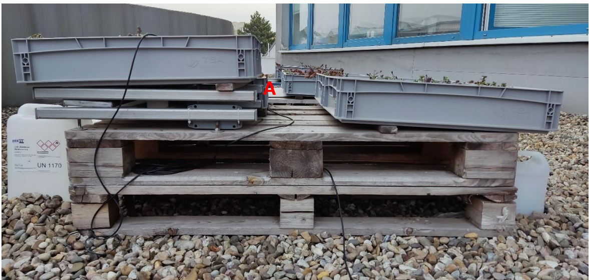
Obr. 14. Uloženie boxov na drevených paletách. (A) Vážiace zariadenie s tenzometrickým senzorom Zemic 6LG.
