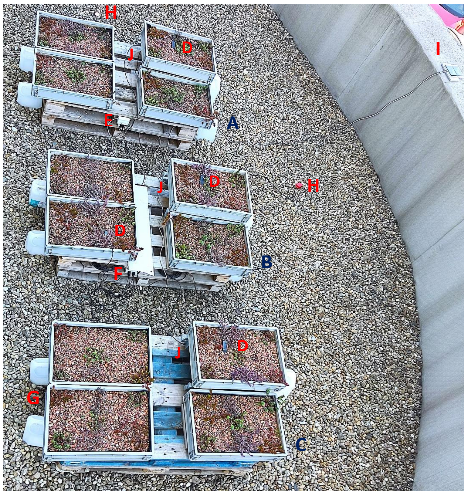
Obr. 13. Rozmiestnenie strešného experimentu: (A) substrát s 20% biouhlia, (B) substrát s 10% biouhlia, (C) substrát bez biouhlia, (D) senzory pôdnej vlhkosti a teploty SMT100, (E) zariadenie Quattro pre zber dát z váh, (F) datalogger Truelog 100, (G) nádoby na zber eluátu, (H) senzory na snímanie teploty, (I) solárny panel napájajúci váhy a zariadenie zberajúce dáta z váh, (J) váhy.
